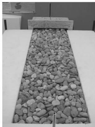
Figure 8 - Déphaseur thermique avec du gravier – Source Hollmuller 2004
