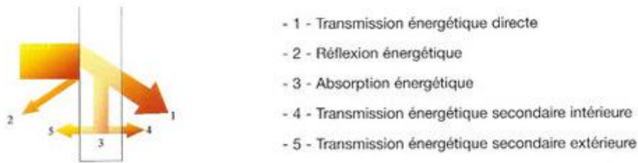
Figure 4 - Echanges radiatifs au niveau d'un vitrage - Source EnergiePlus
